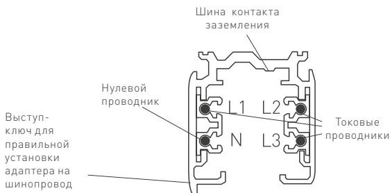
Рисунок 1. Конструкция шинопровода.
